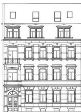
Abbildung 1: Gebäudetypen sind als Gruppen ähnlicher Gebäude aufzufassen, die durch Repräsentanten charakterisiert werden. Das Beispiel zeigt die Kurzcharakteristik (geometrische und baukonstruktive Merkmale) eines Repräsentanten des Gebäudetyps MRG 3 (Mehrfamilienhaus in geschlossener Reihenbebauung; Baualtersstufe 3, d. h. Bauzeit zwischen 1871 und 1914).
